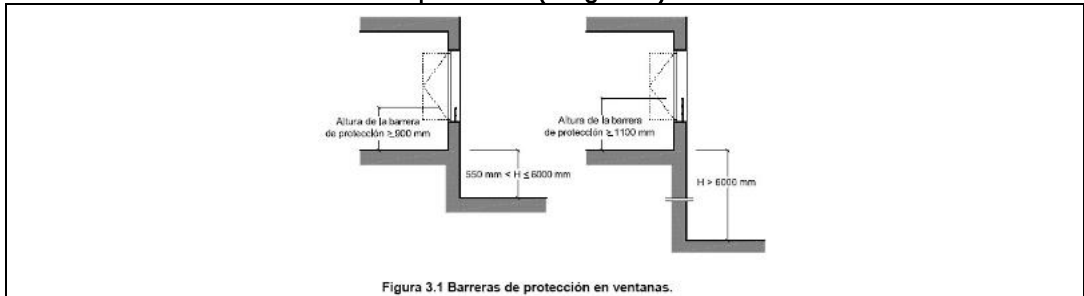
Figura 3.1 Barreras de protección en ventanas.
